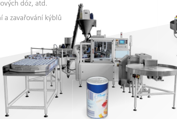
Dávkovací a uzavírací stroj dávkování praškových produktů dle váhy
